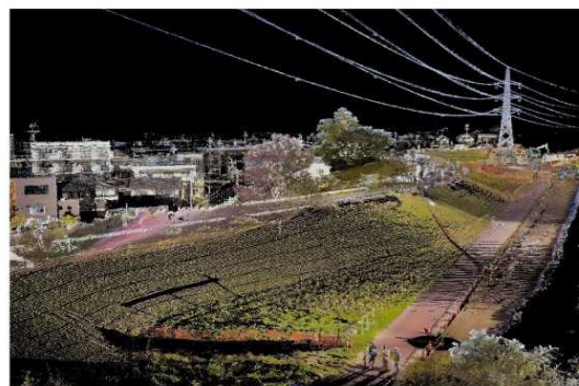
起工測量の結果(点群データ)
