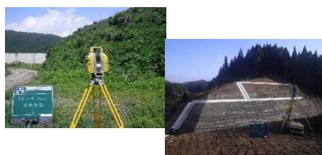
LSによる起工測量及び 出来形検測
