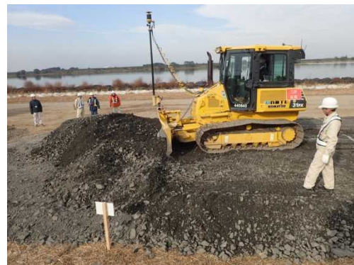
3次元マシンコントロール(ブルドーザ)
