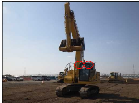
ステレオカメラによる撮影及び現況・完成比較
