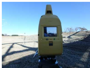
LSを併用して障害物の有る部分を測量
